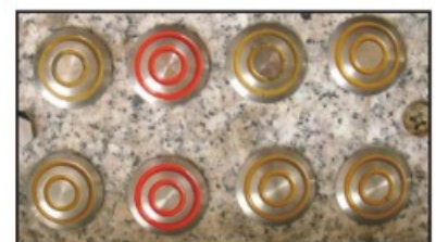
經過10天的測試後 (即約已壓踏131100步)之導行釘
