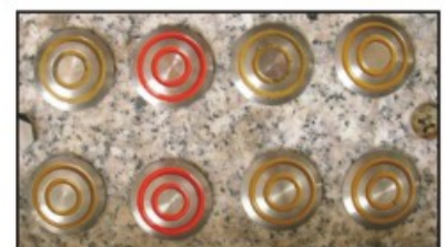
经过 10天的测试後 (即约已压踏131100步) 之导行钉
