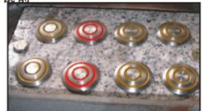
经过 10天的测试後 (即约已压踏131100步) 之导行钉
