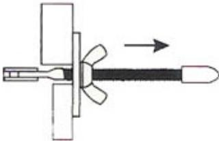
調校尾部使兩塊石材連接平坦，然後再完全收緊螺絲使兩塊石材不能移動；
