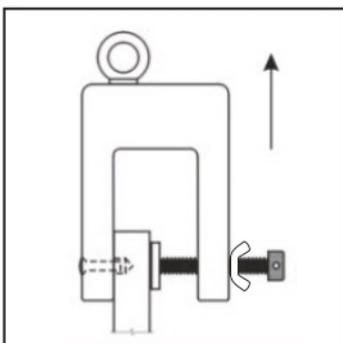
在確定吊石碼已繫穩石材後，可完全提起石材。
