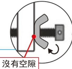
收緊螺絲，目測以確定吊石碼及石材表面中間並沒有空隙，然後扭緊蝶形螺母，之後便可輕拉石材作檢查。
